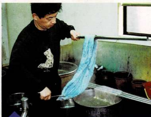
6. 写真5の黄色を呈している絹糸は空気酸化で青色に変化する
